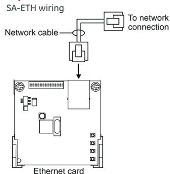
La tarjeta SA-ETH proporciona una conexión de red Ethernet Base T 10/100 estándar para conectarse a la intranet, una red local o internet. La tarjeta se puede utilizar para descargar la programación desde el FX-CU al panel a través de la red.
