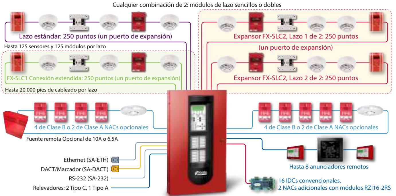
Cada panel FX-1000 tiene espacio para dos módulos de control de lazo en cualquier combinación, simples o dobles, con lazos para 250 dispositivos. El FX-1000 viene con un lazo que admite hasta 125 detectores y 125 módulos.
