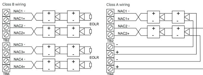
La marca indica la polaridad de la señal de salida cuando el circuito está activo. La polaridad se invierte cuando el circuito no está activo. Alerta los dispositivos de notificación en consecuencia. La polaridad del dispositivo de notificación se muestra en estado activo.
