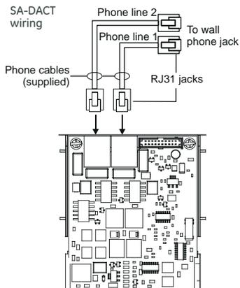
Las líneas telefónicas de marcación se conectan a los puertos de la placa del circuito principal. La línea telefónica 1 es conectada al J4 y la línea telefónica 2 es conectada al J1.
