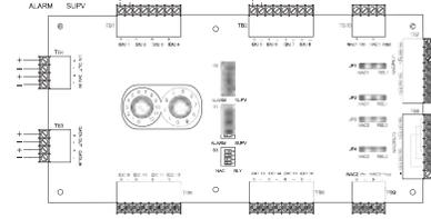
El módulo de interfaz remota de zona RZI16-2RS, es un elemento direccionable que proporciona conexiones para 16 circuitos de dispositivos iniciales clase B y 2 circuitos de salida supervisados de clase B. Las entradas y salidas pueden ser configuradas individualmente para diversos tipos de dispositivos.
